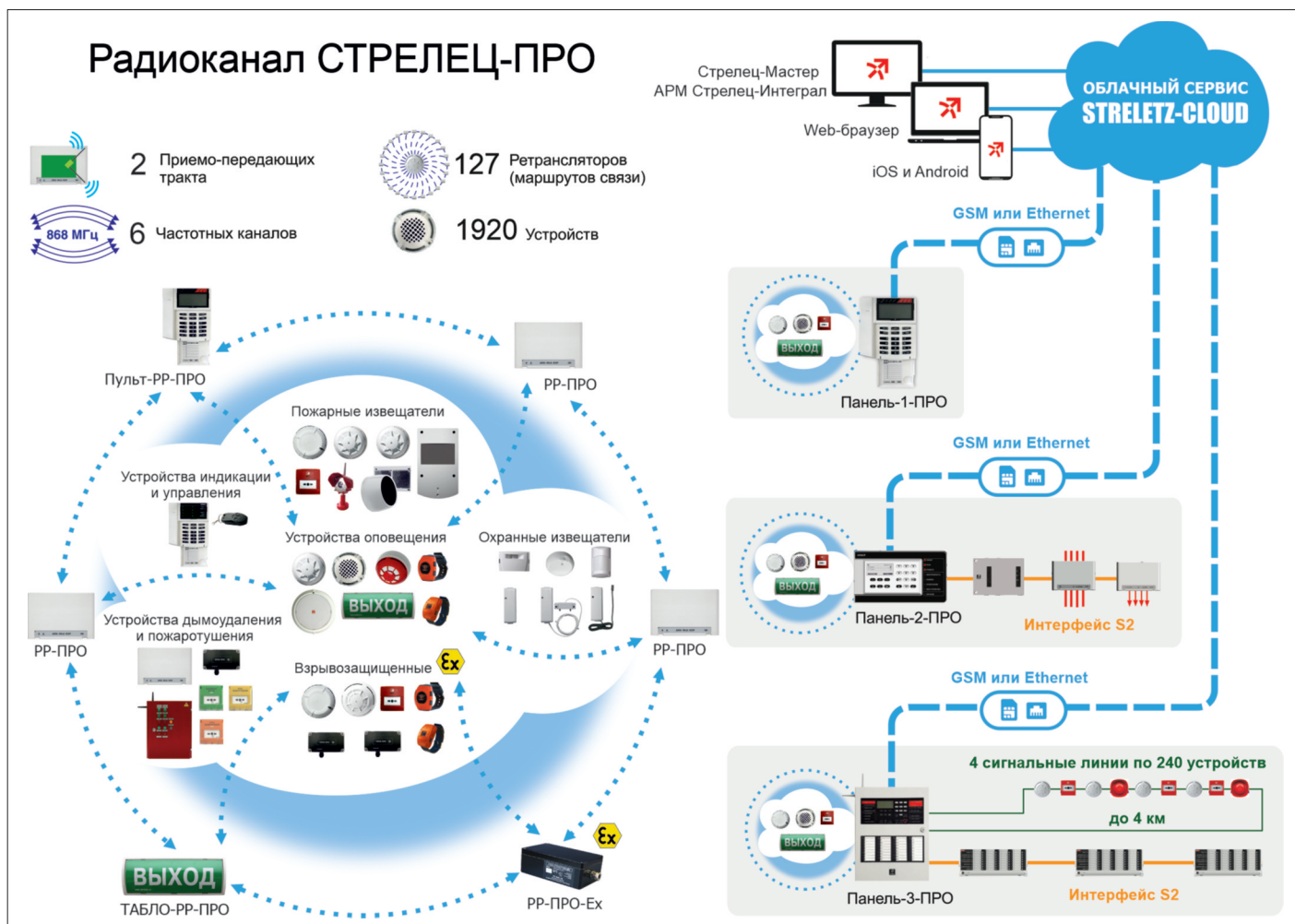
Рис. 2. Структура ИСБ "Стрелец-Интеграл". Новые приемно-контрольные приборы "Стрельца-ПРО"
