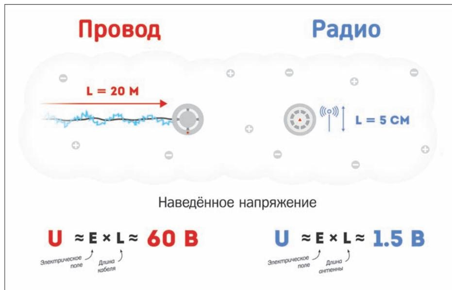
Рис. 1. Кабельные линии – антенны для электромагнитных наводок
